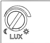
Der Schwellwert des Sensors kann kontinuierlich mittels Drehknopf eingestellt werden.
