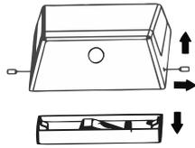
2. Abdeckung durch lösen der Madenschrauben entfernen
